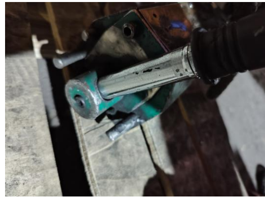
生产部物管磁力起重器定位销变形
