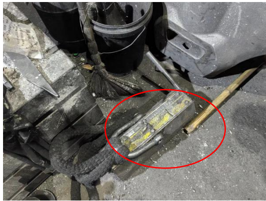
V 法精整损坏的起重器存放在现场
